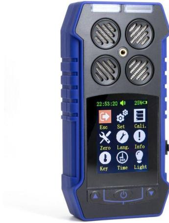
同时检测并显示甲烷（CH<sub>4</sub>）/可燃（EX）、一氧化碳（CO）、氧气（O<sub>2</sub>）、硫化氢（H<sub>2</sub>S）等四种气体。适用场所：煤矿井下、冶金、炼焦、石化化工、市政、燃气、环境监测、坑道作业等多种场所现场检测。可与外置吸气泵配合使用实现坑道内或人员无法到达场所的气体浓度测量，可配外置泵。
